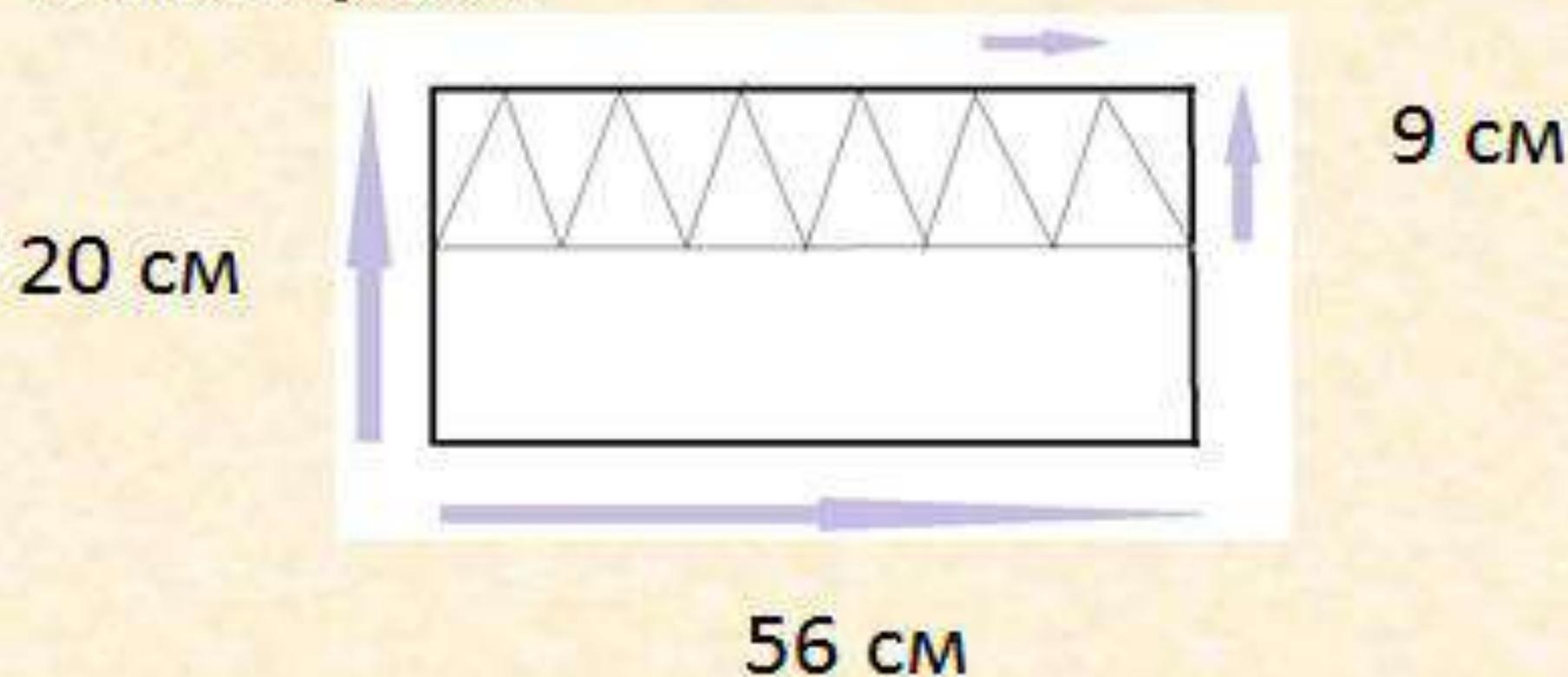
Треугольники вырезать так, чтобы получился зубчатый верх (из шести зубьев). Тщательно промазать клеем противоположные торцы детали и дав подсохнуть промазаным краям 10—15 мин, соединить их встык. Затем тщательно промазать клеем торцы «зубьев короны» по всему периметру цилиндра. Дав просохнуть клею 5 мин соединить зубцы попарно между собой так, чтобы вершины соединились в центре. Должна получиться сферичная (округлая) шапочка.
